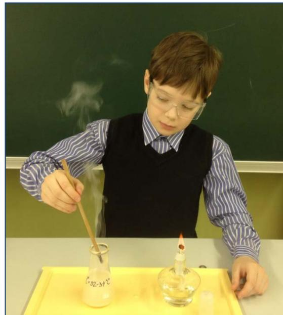
Рис. 10. Лучина погасла под влиянием углекислого газа, выделяемого в процессе брожения
