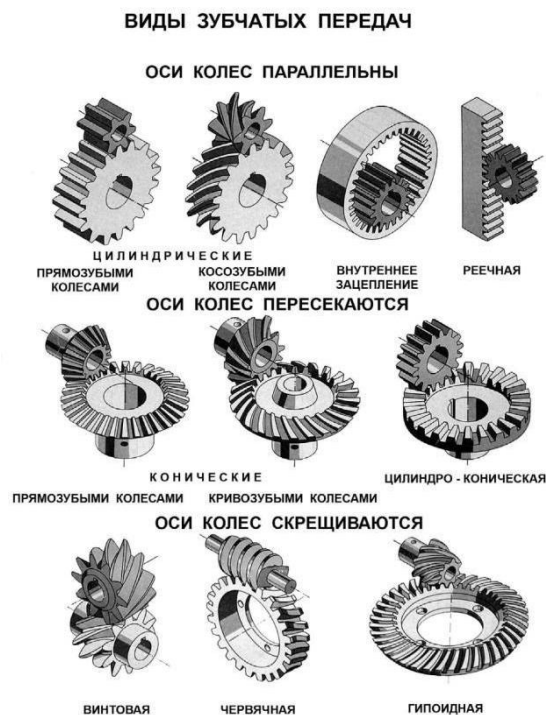
Рис. 1. Зубчатые передачи
