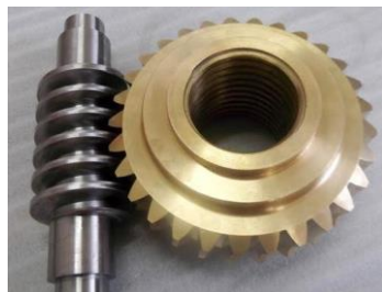
Рис. 7. Червячная передача
