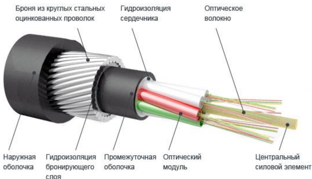
Рисунок 14. Конструкция оптоволоконного кабеля
