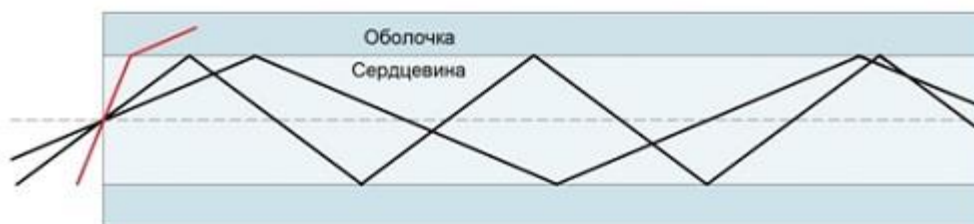
Рисунок 13. Принцип действия оптического волокна
