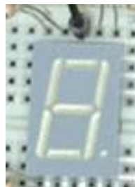
Рисунок 1 Одноразрядный семисегментный индикатор
