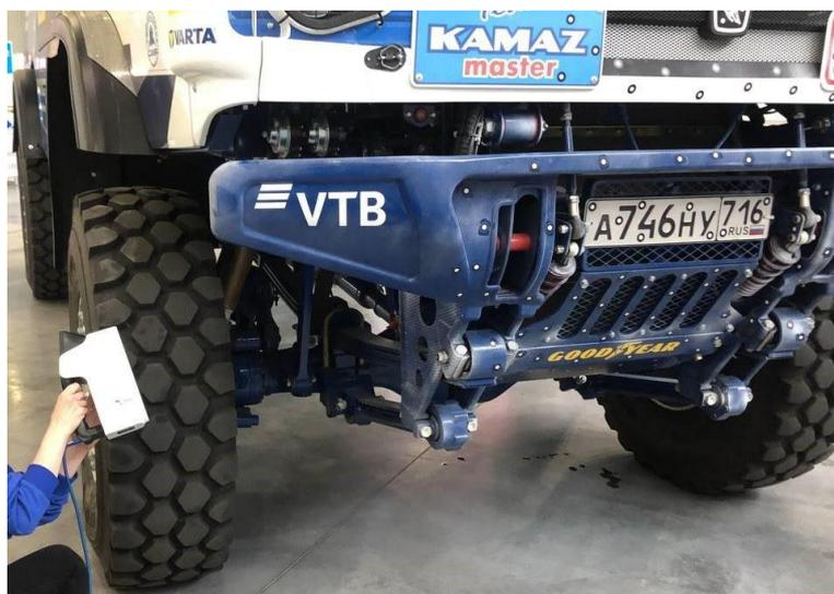
Рисунок 9.1 – Процесс сканирования бампера автомобиля ручным 3D сканером
