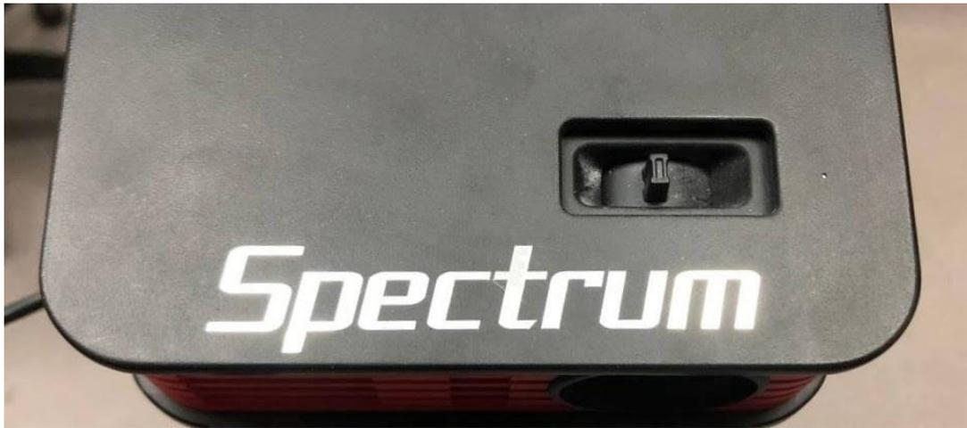
Рисунок 9.8 – Рукоятка регулировки фокусного расстояния
