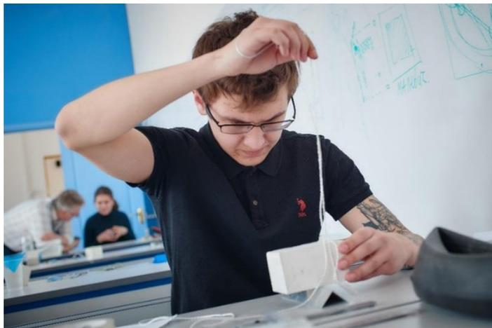
Рис.2-б. Определение оси симметрии
