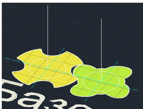
Использовать команду сдвиг с закручиванием, в качестве профиля сдвига выбрать исходные профили, в качестве траектории выбрать оси
