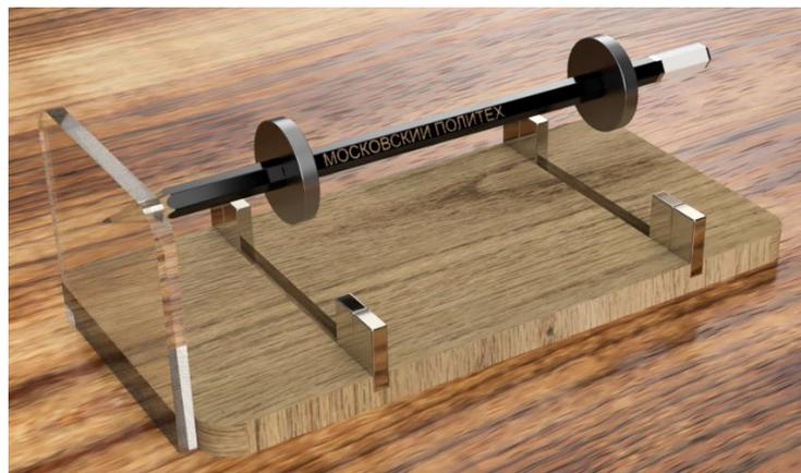
Рис. 121. Демонстрационный стенд магнитный подшипник
