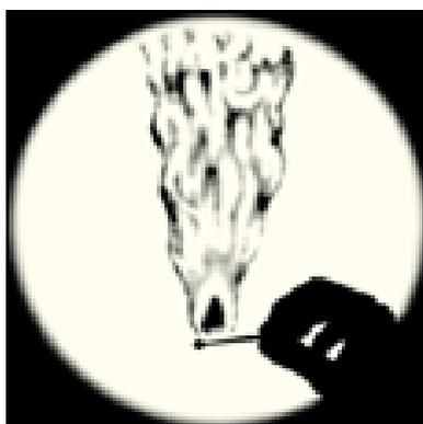
**Рис. 8.1 . Наблюдение явления естественной конвекции воздуха в опыте с тенью от пламени спички**
