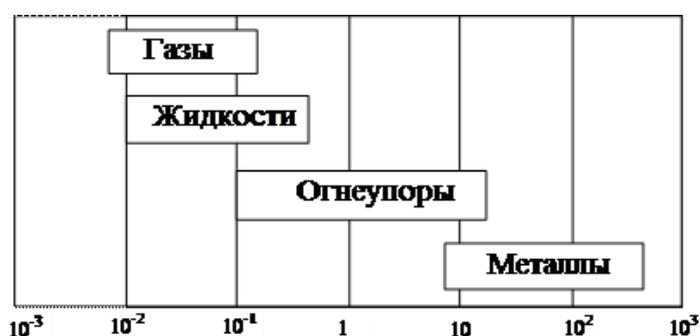
Рис. 7.1. Диаграмма значений теплопроводности веществ, Вт/(м·К)
