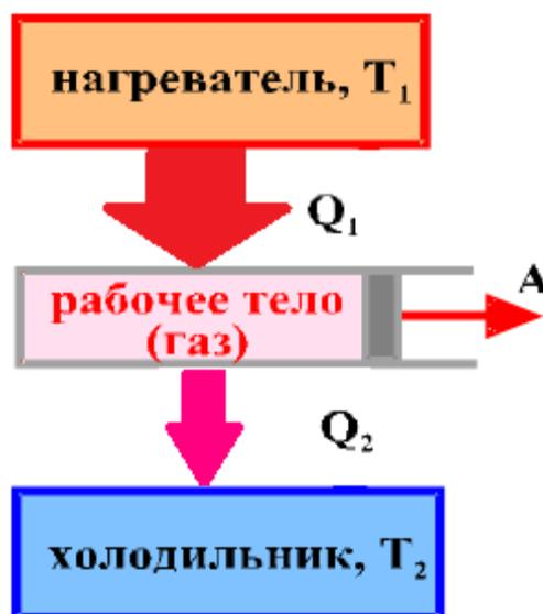
Рис. 2.4. Принцип действия теплового двигателя
