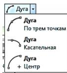
трем точкам» и укажем последовательно первую точку на нижней дуге диаметром 30 мм, а вторую на окружности диаметром 48 мм. Третья точка задается таким образом, чтобы сформировать выпуклость в соответствии с заданием, а в окошке задается величина радиуса сопряжения (рис. 6.9).
