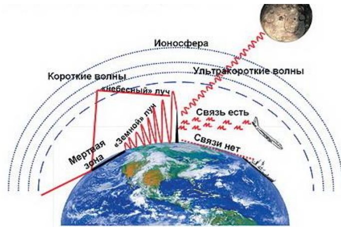
Рис. 20. Наглядное представление распространения радиоволн КВ и УКВ диапазонов
