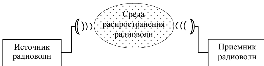
Рис.1. Схема информационного обмена при помощи радиоволн
