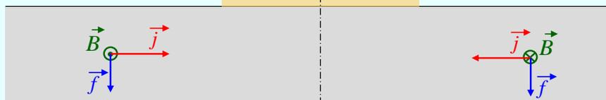
Пандеромоторная сила оказывает на обшивку воздушного судна давление, направленное внутрь, вне зависимости от направления разрядного тока.
