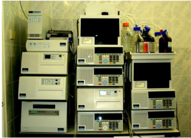
Система высокоэффективной ионной хроматографии PE 200 Series (PerkinElmer, США)
