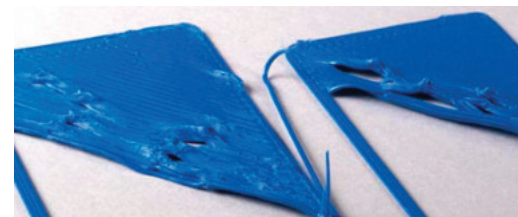
Рисунок 2.2.6 – Отсутствие адгезии (прилипания) 1-го слоя модели
