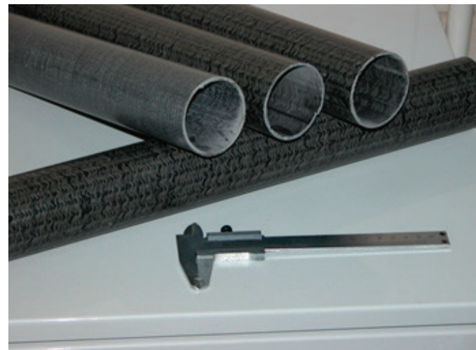
Рисунок 5.5.1 – Трубы из стеклопластика, полученные с использованием технологии мокрой намотки
