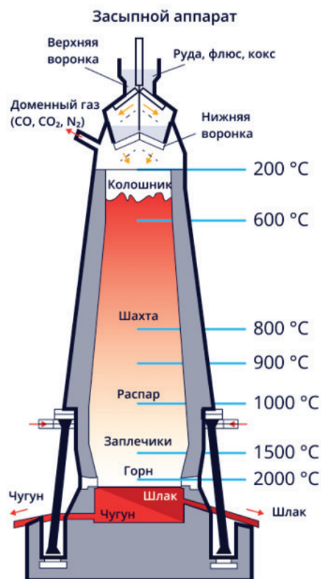
Рисунок 5.2.5 – Схема выплавки в доменной печи
