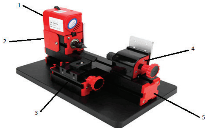
Рисунок 3.2.26 – Учебный модульный токарный станок: 1 – привод станка (мотор); 2 – передняя бабка; 3 – суппорт; 4 – задняя бабка; 5 – станина
