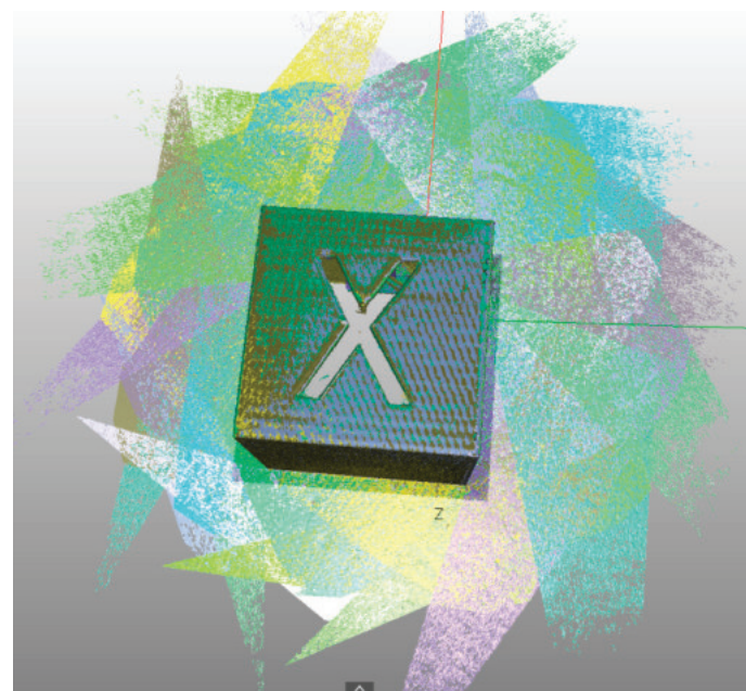
Рисунок 6.4.5 – Результат съемки объекта на поворотном столе
