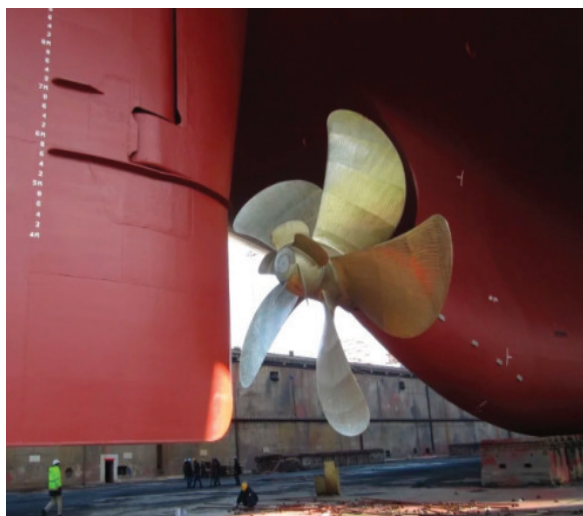
Рисунок 4.1.1 – Художественные изделия (а, б) и гребной винт корабля (в), полученные литьем
