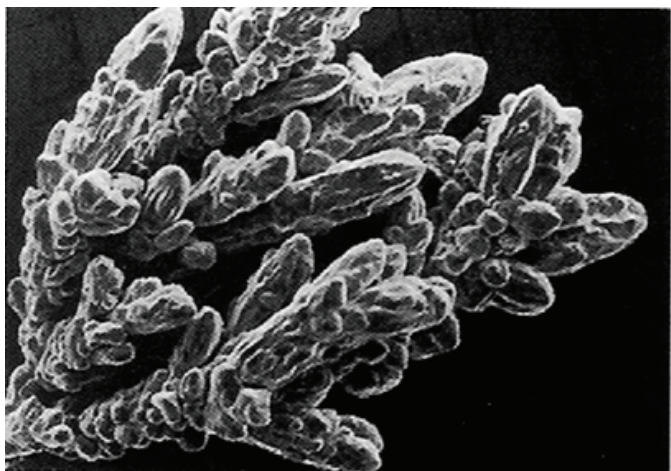
Рисунок 4.3.5. Частица медного порошка, полученная электролизом
