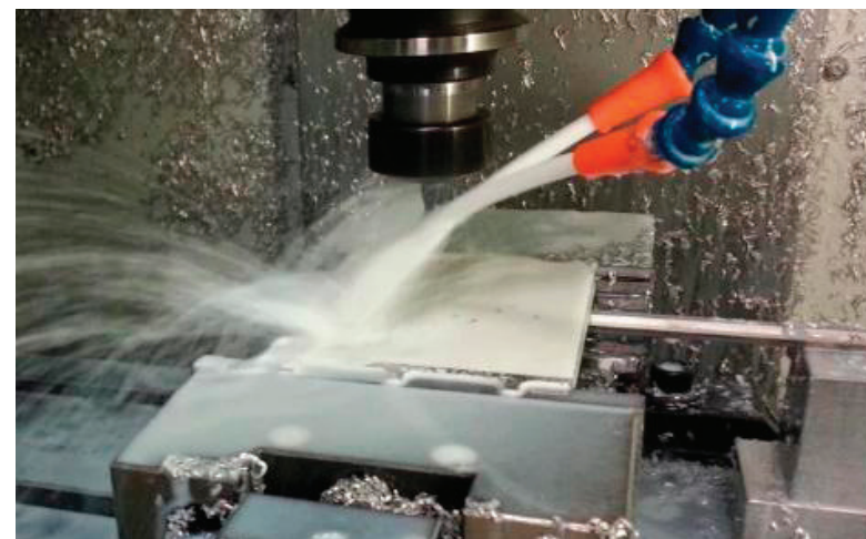
Рисунок 3.3.17 – Работа системы СОЖ
