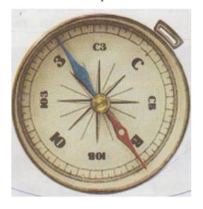
МАГНИТНАЯ СТРЕЛКА КОРПУС ПРЕДОХРАНИТЕЛЬ
