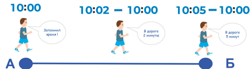
Рисунок 8.1 – Алгоритм таймера на millis()
