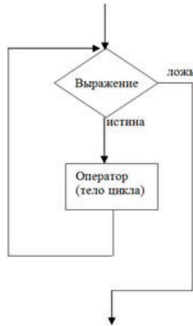
Рисунок 7.6 – Блок-схема алгоритма, реализующего работу цикла while
