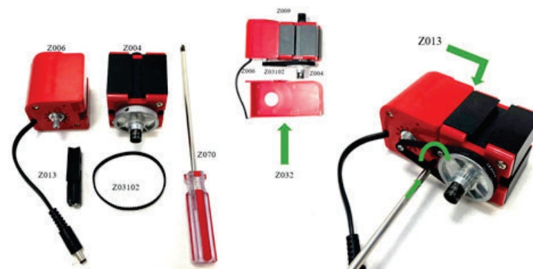
Рисунок 3.28 – Сборка и регулирование шпиндель-мотора
