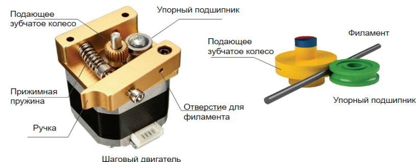
Рисунок 7.24 – Устройство подающей машины
