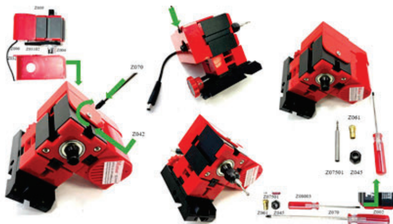
Рисунок 3.30 – Установка защитного кожуха и инструмента на модуль фрезерной головы
