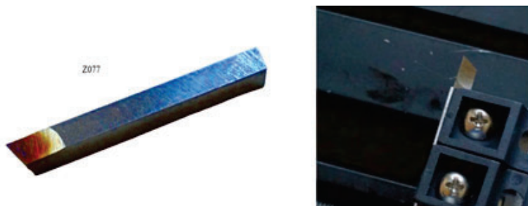
Рисунок 3.17 – Токарный резец и его вид в установленном положении
