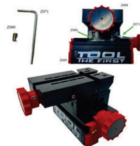
Рисунок 3.13 – Фиксация направляющих и готовая сборка узла
