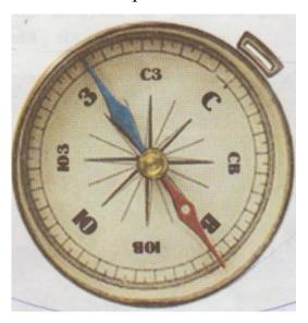
МАГНИТНАЯ СТРЕЛКА КОРПУС ПРЕДОХРАНИТЕЛЬ
