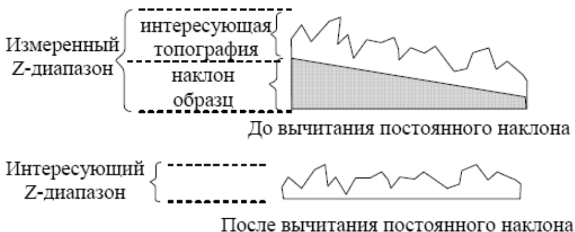
Рис. 6.27: Устранение постоянного наклона из СЗМ-изображения
