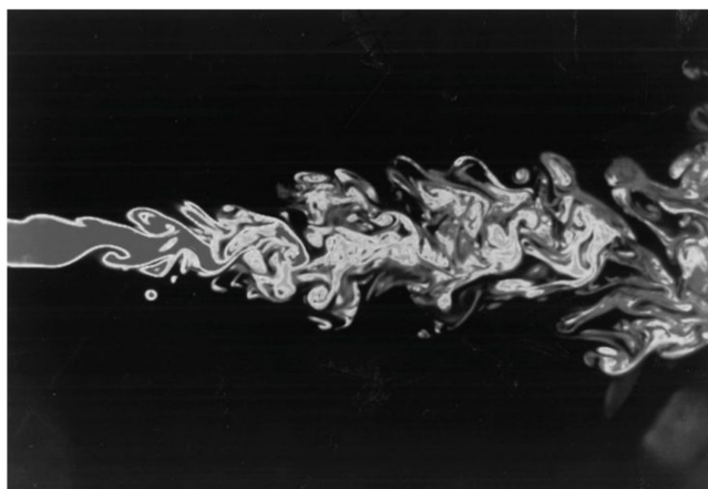
Рис. 3.6: Переход от ламинарного (слева) в турбулентному течению в струе жидкости.
