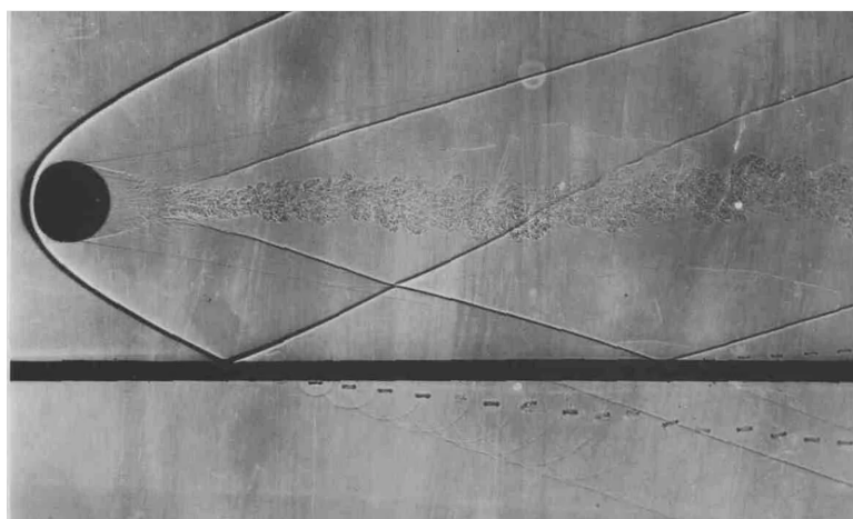
Рис. 3.7: Сверхзвуковое обтекание шара. Видна ударная волна, возникающая перед шаром и ее отражение от плоскости в нижней части фото
