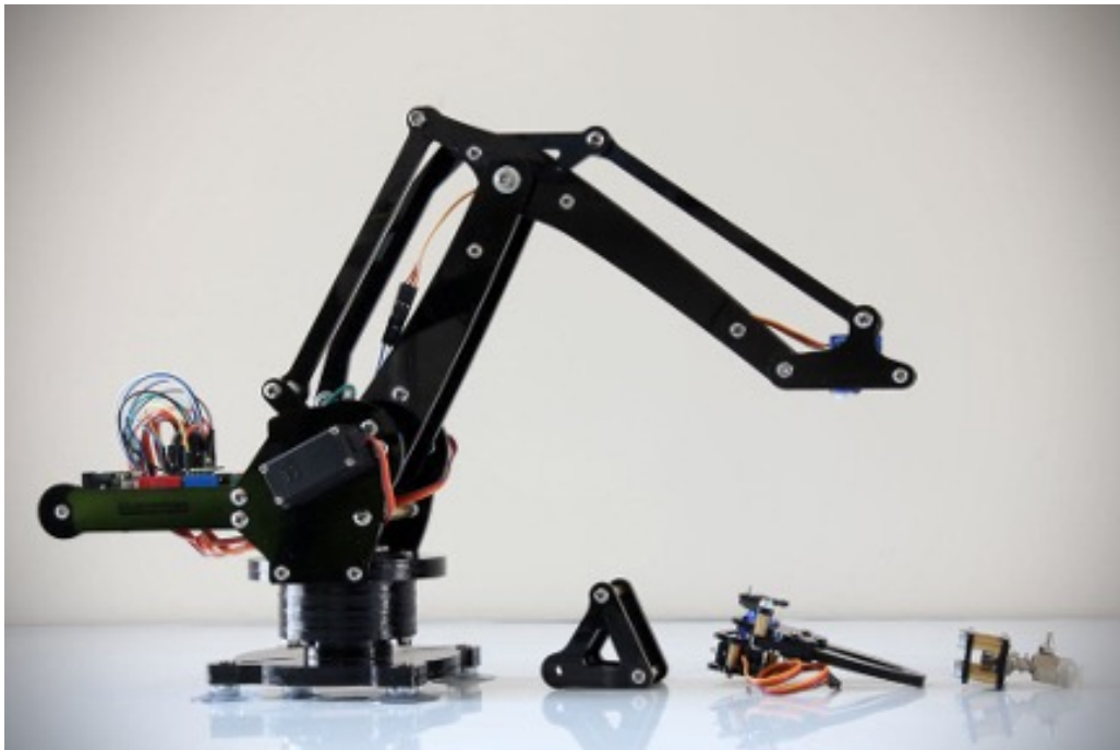
Рис. 2.2: Простой манипулятор с плоско-параллельной кинематикой (перемещение стрелы и поворот)
