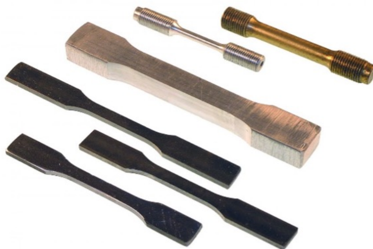
Рис. 2.7: Образцы различных металлов, подготовленные для разрушающих испытаний и определения механических свойств
