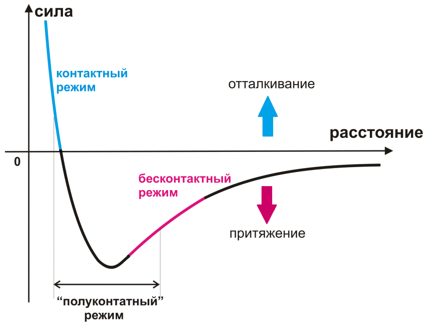
Рис. 6.22: Качественная зависимость силы межатомного взаимодействия от расстояния между атомами
