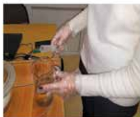
Рис. 3. Проведение процесса фото-Фентона (под видимым светом) для очистки проб воды из р. Ликова объёмом 0,5 л (A) и 5 л (B)
