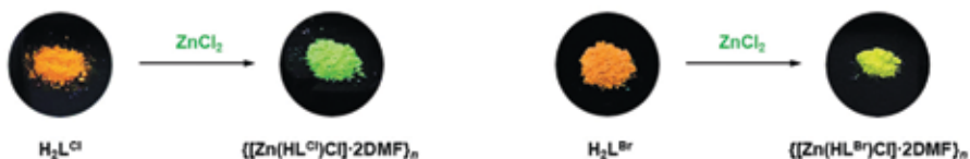
Рис. 2. Изменение цвета люминесценции при комплексообразовании. Фотографии выполнены при облучении соединений длиной волны 365 нм
